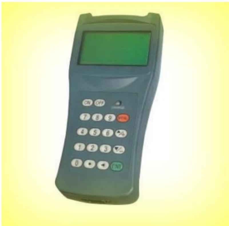
O medidor de vazão ultrassônico EU-109H funciona com tecnologia ultrassônica e mede pelo princípio da diferença horária. Há um par de vibrador ultrassônico e receptor na parte externa do tubo emitindo em duas direções e ambos frente a frente. O vibrador de luz emitirá sinais ultrassônicos a jusante e invertido. Medindo a diferença de tempo da transmissão nas duas direções, você obterá a vazão do fluido; em seguida, insira o diâmetro do tubo, você obterá o fluxo.
